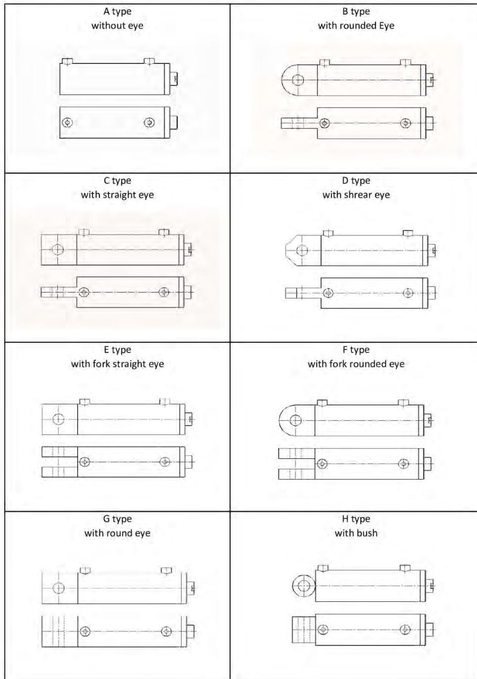
**CYLINDER ENDS FOR HYDRAULIC CYLINDERS**
